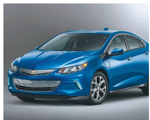
2월1일 시판을 시작하는 주행거리 연장 전기차 볼트는 기존 1세대 모델에 비해 12%의 효율을 개선해 전기 모드로만 최대 89km를 달릴 수 있는 것이 특징이다. 사진제공 | 한국GM
