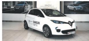
르노삼성자동차는 '한불 공동 자율주행시스템 개발 프로젝트'(사진)가 국토교통부 자율주행 자동차 임시운행 허가를 받아公道 시험 주행을 도입한다고 30일 밝혔다. 자율주행차를 통해 혼잡한 도로에서 저속으로 운전자의 가감속 및 자동 조향 주행을 지원하는 '혼잡주행 지원시스템'(Traffic Jam Assist) 개발 프로젝트를 진행 중이다. 사이트 레이더, 카메라 등 보급형 센서 시스템으로 구성된 차량으로 시속 50km 미만의 속도로 혼잡한 도로에서 차선 유지, 차간 거리 및 속도 유지 등의 기능을 시험할 예정이다.
