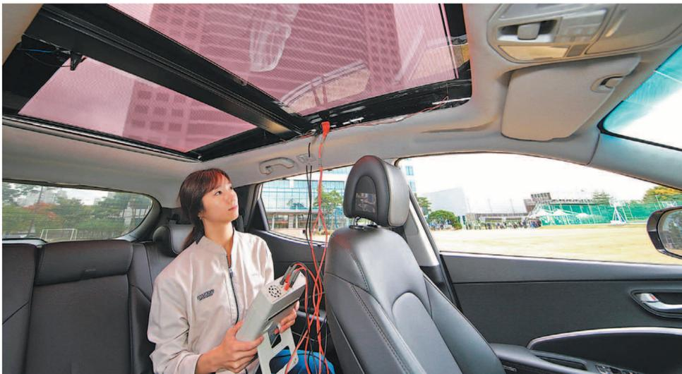
현대·기아차 연구원이 투광이 가능한 2세대 솔라루프가 설치된 자동차 안에서 효율을 측정하고 있다. 현대·기아차는 태양광을 이용해 달리는 자동차를 충전하는 솔라 시스템 관련 기술을 공개했다.
