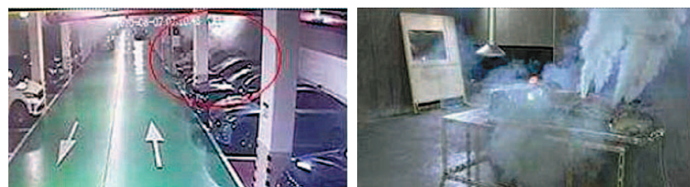
대구 칠곡에서 발생한 코나 EV 화재(왼쪽) 영상과 자동차안전연구원(KATRI)이 인위적인 화재를 통해 재현한 배터리셀 내부 열 폭주 시험 영상. 두 영상은 유사점이 있는 것으로 확인됐다. 사진제공 | 국토교통부
