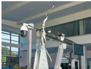
훈련 영상을 실전용 분석을 위해 자동 편집해 주는 딥러닝 비전 인공지능 코치, 70m 거리에서 슈팅머신으로 화살을 쏘아 신규 화살의 불량 여부를 테스트하는 고정밀 슈팅 머신, 정밀 센서 기반의 '전자 과녁'을 적용해 점수를 자동으로 판독하고 저장하는 점수 자동 기록 장치, 3D 프린팅을 활용한 선수 맞춤형 그립(위부터 시계방향). 사진제공 | 현대차그룹
