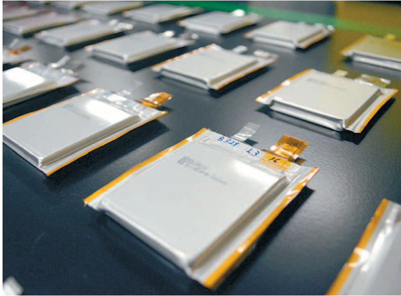
치차오 후 SES CEO가 4일 ‘SES 배터리 월드’ 행사에서 기존 리튬이온계 배터리에 비해 에너지밀도가 약 30% 가량 높은 하이브리드 리튬메탈 배터리의 특징을 설명하고 있다(왼쪽사진). SES가 개발한 하이브리드 리튬메탈 배터리 ‘아폴로(Apollo)’.
