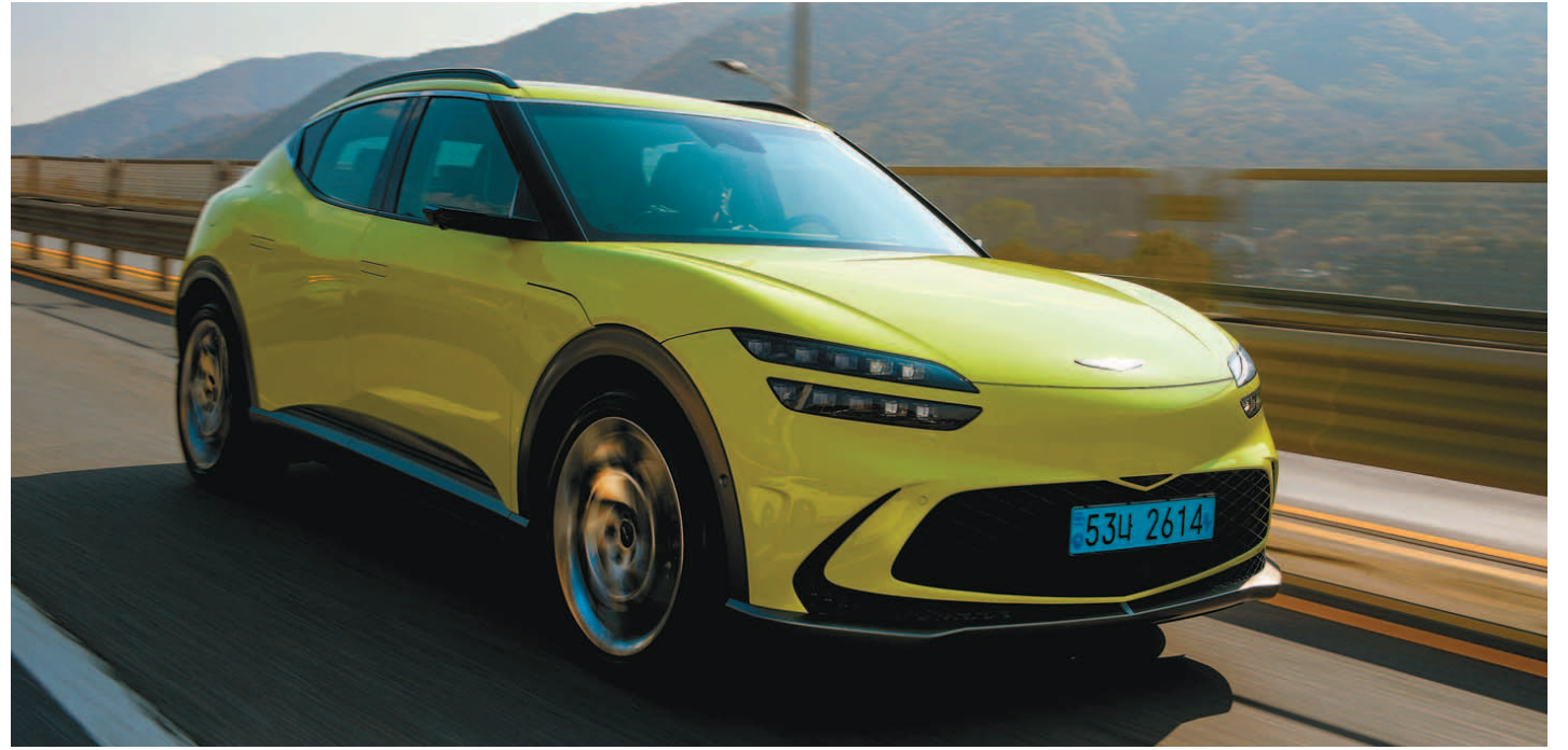
제네시스 GV60 퍼포먼스 AWD 모델은 부스트모드 사용시 최대 출력 360kW, 제로백 4.0초의 폭발적인 성능을 발휘한다. 프리뷰 전자제어 서스펜션과 전자식 차동제한장치(e-LSD) 등을 통해 승차감과 주행 안정성을 대폭 강화했다. 사진제공 | 제네시스
