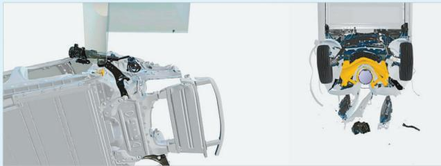
충격으로 인한 이탈되는 부품이 차량 바깥쪽으로 향하게 해 배터리와 차내 승객을 보호하는 'SPOC 블록' 기술 이미지(왼쪽). 전방 충돌 시 외부 물체의 실내 유입을 방지해 승객과 배터리 팩을 보호하는 'FLLP' 기술 이미지. 사진제공 | 폴스타
