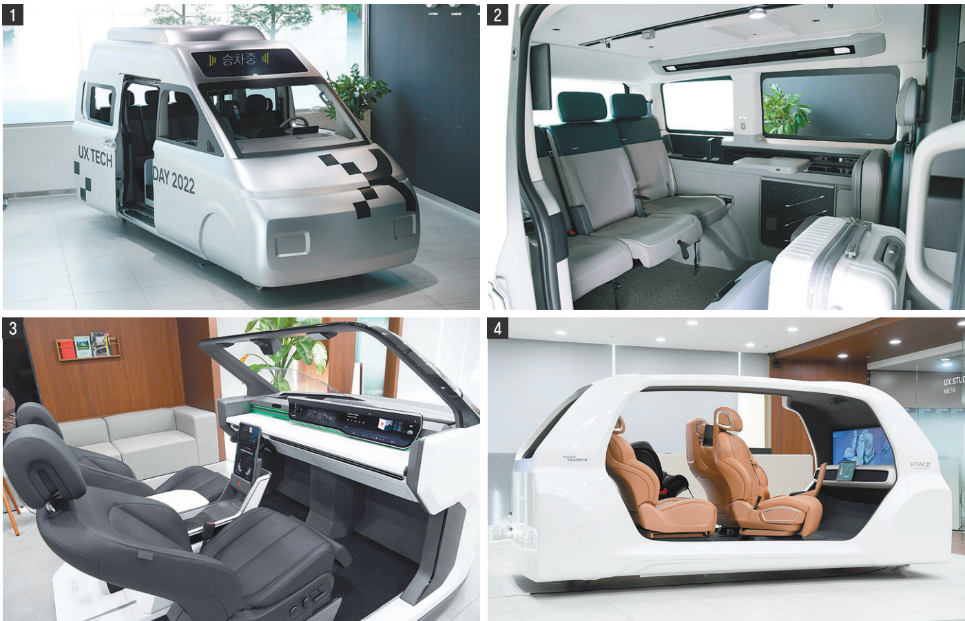
1 2 2025년을 목표로 개발 중인 PBV 전용 전기차 플랫폼 기반의 공항 픽업용 PBV 외관 및 인테리어. 3 현대모비스의 '모드 변환 콕핏'. 4 현대트랜시스의 '다목적 모빌리티 시트 시스템'.
